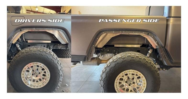
STEP 3: INSTALL THE REAR INNER FENDER BACK PANEL (DRIVERS SIDE & PASSENGER SIDE)
